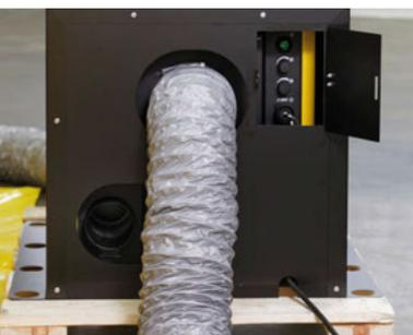
Die Drybox verfügt über passende Schlauchanschlussöffnungen sowie eine Serviceklappe zur Konfiguration der Geräte. Die Mietversion wird inkl. Palette geliefert.
